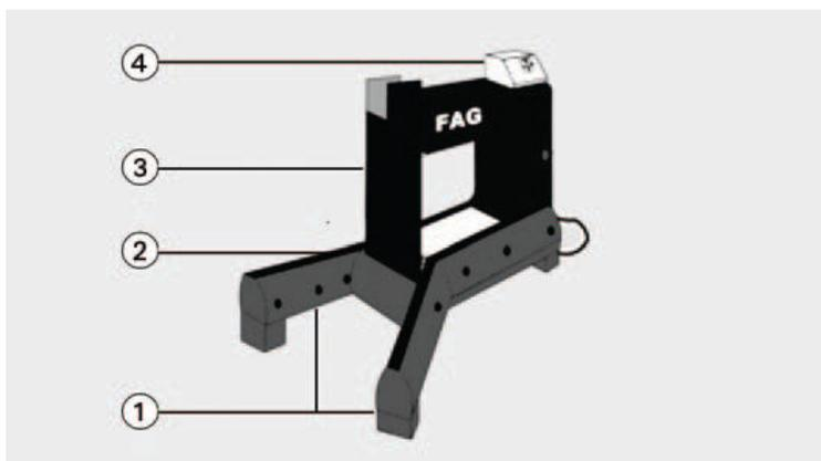
При горизонтальном положении прибора использовать опорные колодки. Выступающие поверхности опорных стоек дополнительно поддерживают большие подшипники. Регулируемая консоль (4) может быть повернута на 90 градусов в удобное положение.
